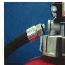
× 緊結ネジの破損 × ホースの脱落
