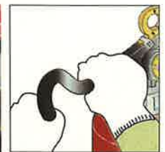
ホースの点検方法 たわませてホースの 状態をチェック
