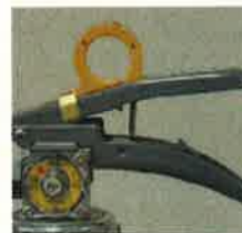
× レバー支えの脱落
