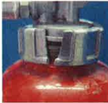
× キャップの破損
